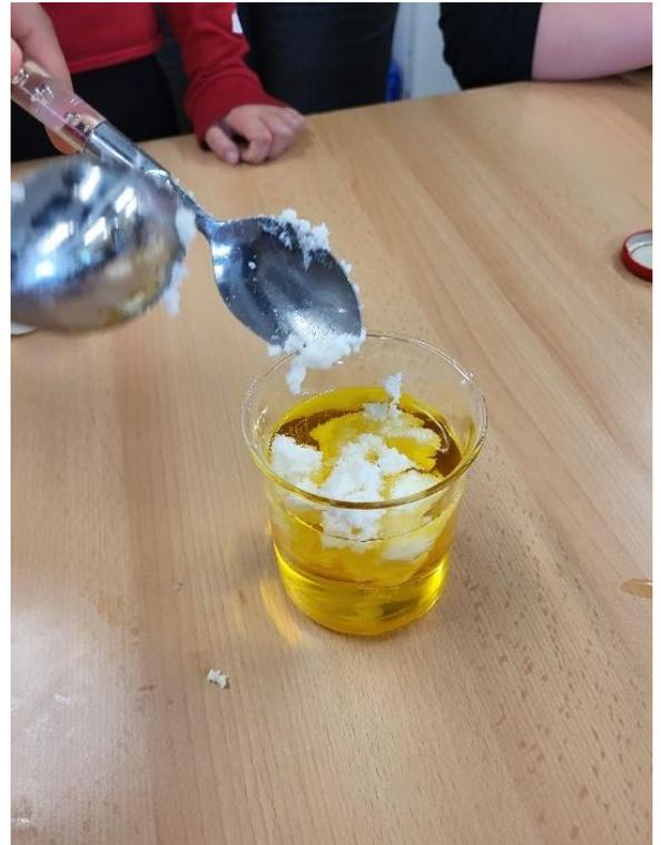
Dieses Gemisch wird erhitzt. Dadurch verbinden sich alle Komponenten zu einer gelben Flüssigkeit. Vorsichtig füllen wir die Flüssigkeit in unsere Tiegel.
